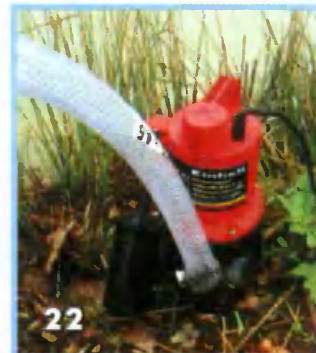
Двигатель всей системы – небольшой насос, установленный в пруду и подключенный к трубе для перекачки воды
