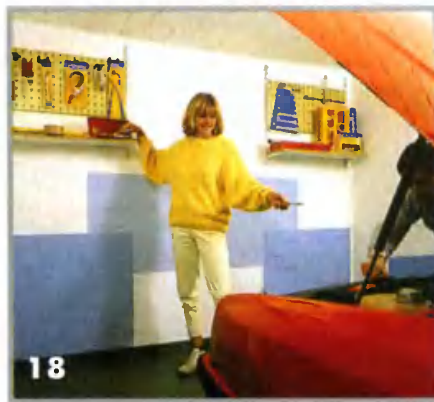
18 Обустройство гаража. Кассеты для инструментов, изготовленные из листовой стали, подвешивают на стеллажных шинах, прикрепляя их дюбелями к стенам
