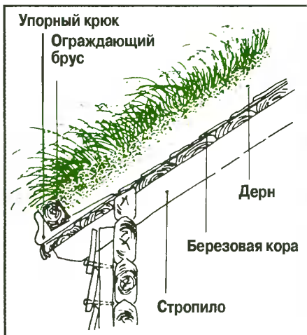
Рис. 12. Ограждающий брус, удерживаемый упорным крюком, который закреплен поверх обрешетки
